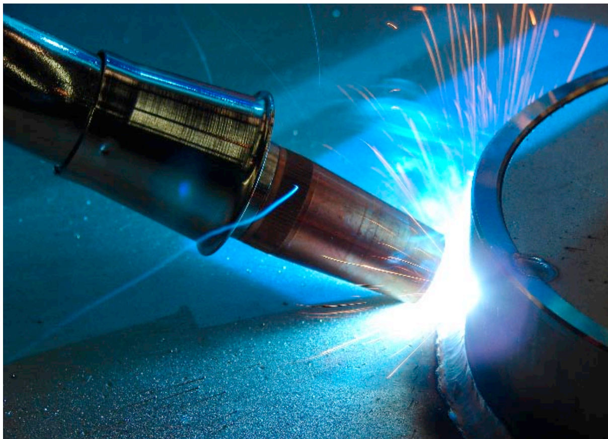
Een close-up van de Aspirmig 350 met verbeterde toortsafzuiging
